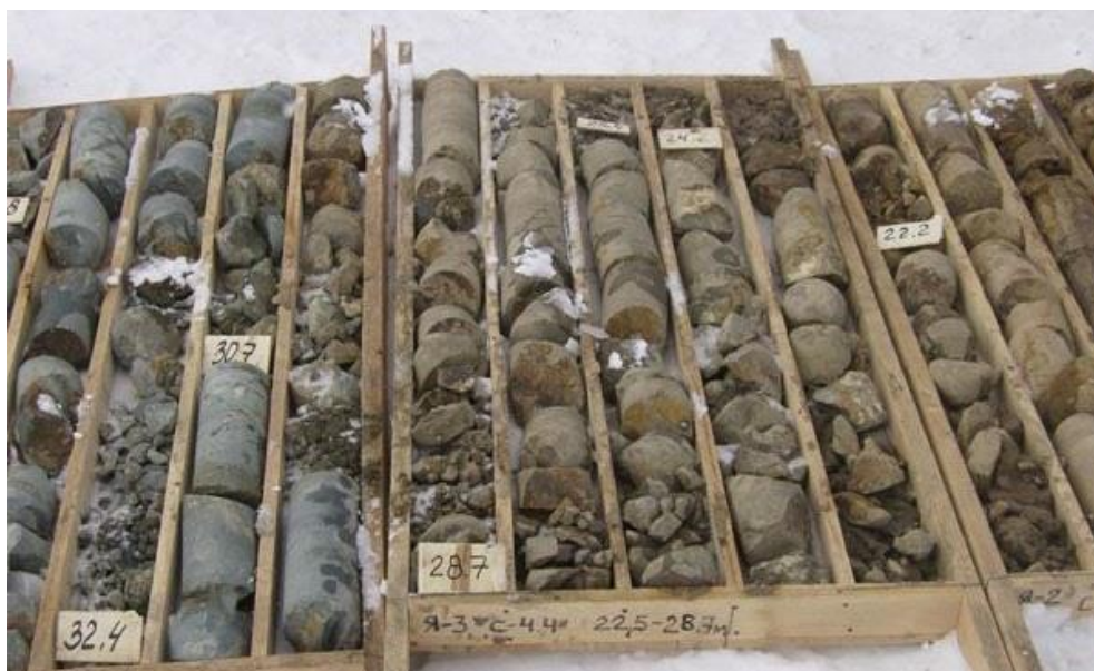
Рисунок 4 – Анализ образцов-керна грунтобетона при контроле качества работ
