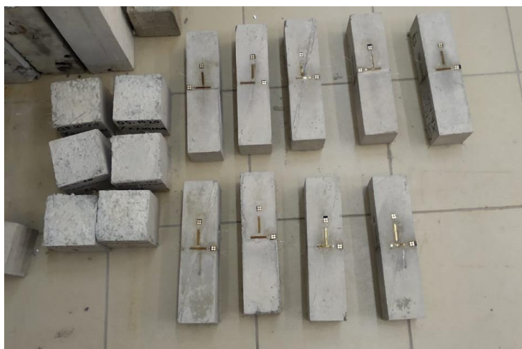
Рисунок 1 – Фибробетонные образцы приготовленные для испытаний
