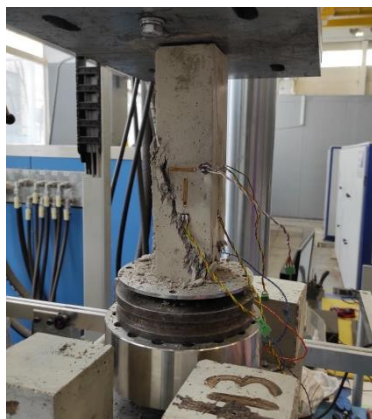
Рисунок 3 – Общий вид образцов по результатам испытаний: кубы (а); призма в испытательной машине (б); общий вид призмы (в)
