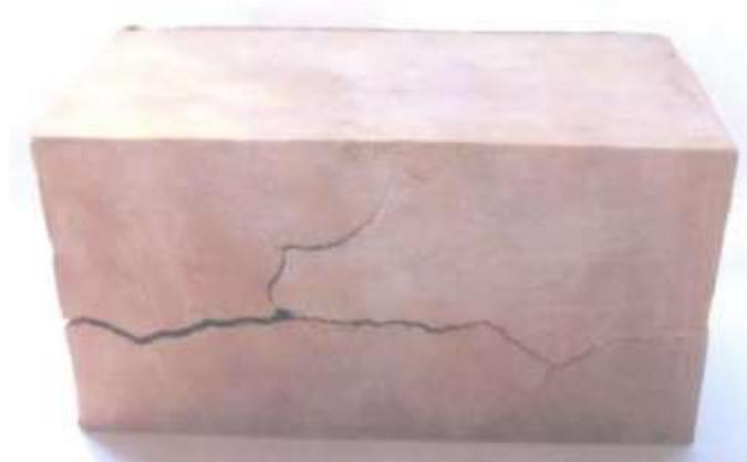
*Рисунок 3 – Образец из бейделлитовой глины, обожженный при 1000°С*
