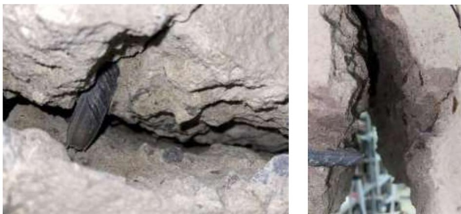
Рисунок 11 – Разрыв арматуры на втором полуцикле нагружения в балках VI и VII серий
