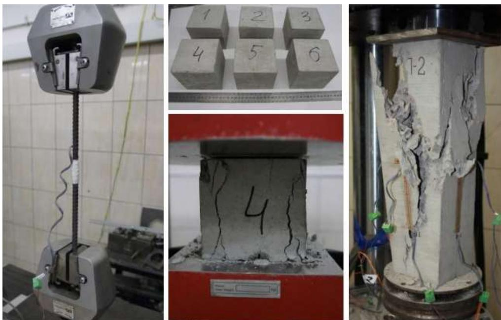
Рисунок 1 – Испытание арматурных стержней, бетонных кубов и призм
