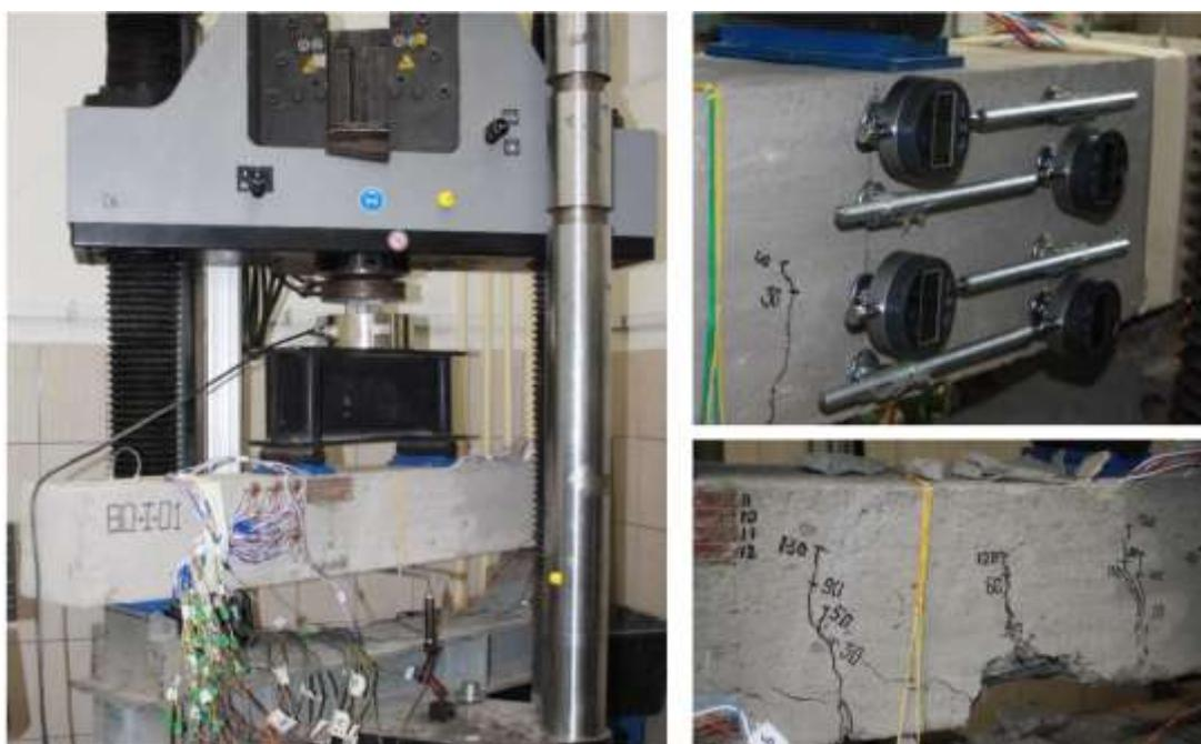
Рисунок 2 – Схема испытаний эталонных балок I серии
