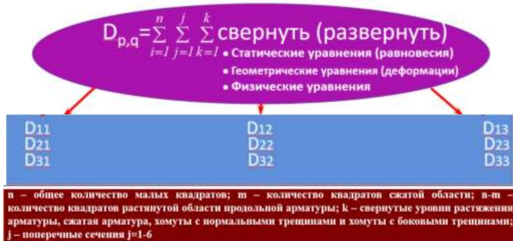
Рисунок 4 – Схема вычисления жесткости прямоугольных поперечных сечений с помощью малых квадратов матрицы  $3 \times 3$  в элементах  $a_{ij}$  для параметров от  $D_{11}$  до  $D_{33}$
