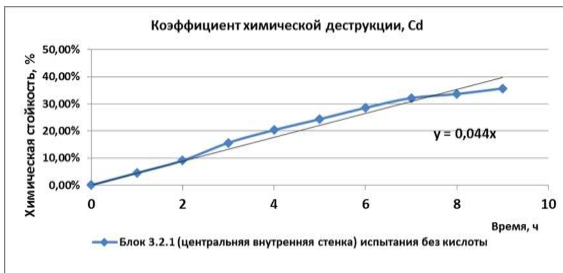
Рисунок 10 – Коэффициент химической деструкции материала центральной внутренней стенки блока при проведении исследований без HCl
