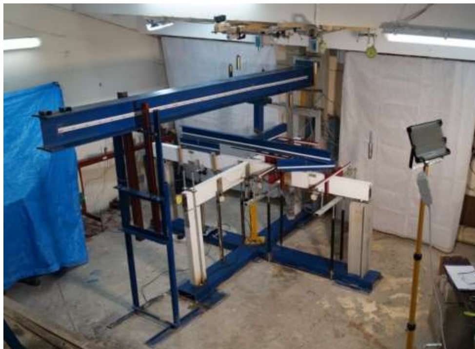
Продолжение рисунка 1 - Конструкция опытного образца рамы: г – общий вид; 1 – выключаемая стойка с динамометром, 2 – неподвижная опора, 3 – связь, 4 – опорные пластины, 5 – выносной кронштейн
