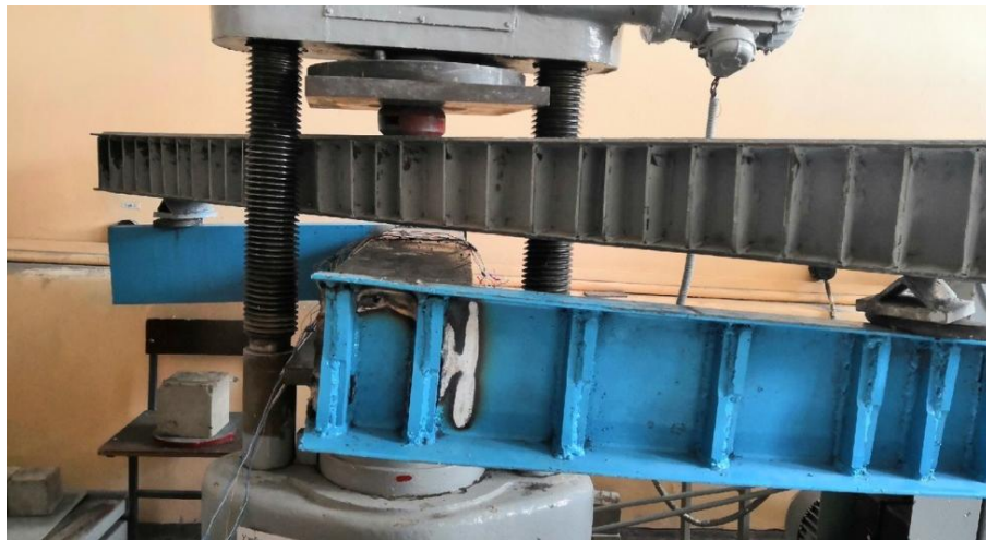
Рисунок 2 - Процесс испытания балки
