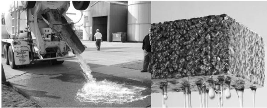
**Рисунок 1 – Сплошное покрытие из высокопроницаемого бетона [31]**
