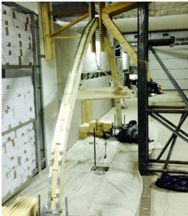
Рисунок 7 - Плоская арочная гирлянда усиленная двумя стальными перфолентами по верхней грани. Приложение нагрузки в зоне конька.
