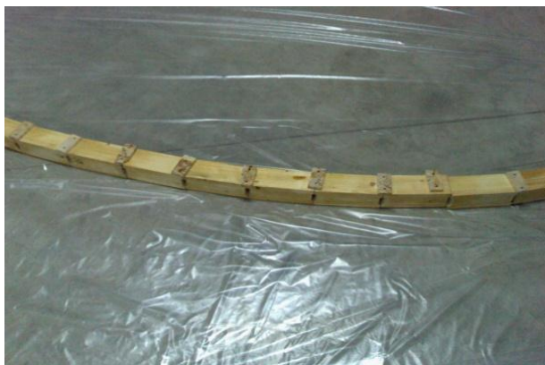
Рисунок 5 - Плоская арочная гирлянда с межэлементными проставками на этапе монтажа
