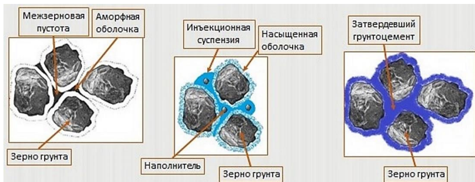
Рисунок 2 - Физическая модель грунтового массива, инъекционно закрепляемого суспензиями тонкодисперсных вяжущих
