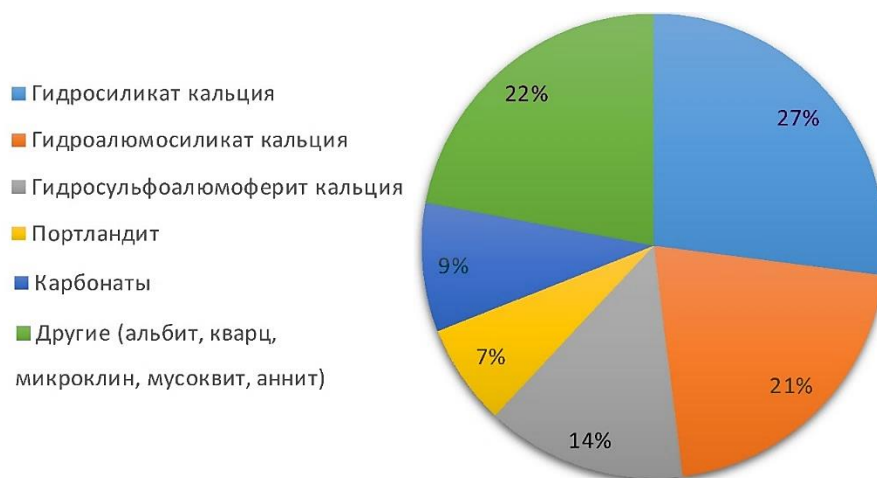
Рисунок 3 - Баланс продуктов гидратации грунтобетона: «Интроцем Экстра»; В/Вяз=3,0; грунт – песок мелкий M_k=1,2
