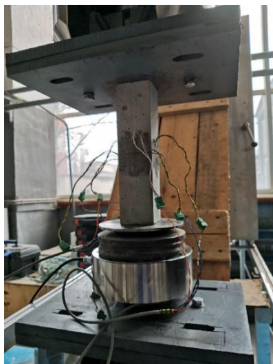
Рисунок 3 – Общий вид высокоскоростного нагружения опытных образцов на оборудовании LabTest
