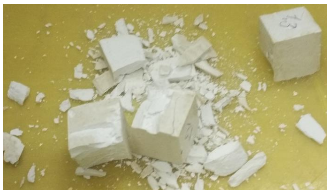
Рисунок 2 – Образец после испытания на сжатие
