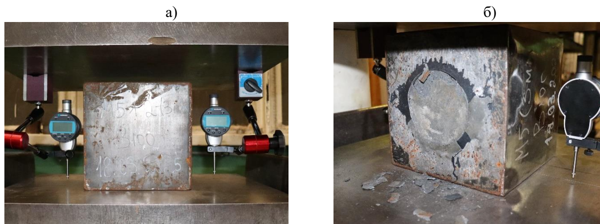
Рисунок 5 – Общий вид моделей-кубов, испытанных на одноосное сжатие.
