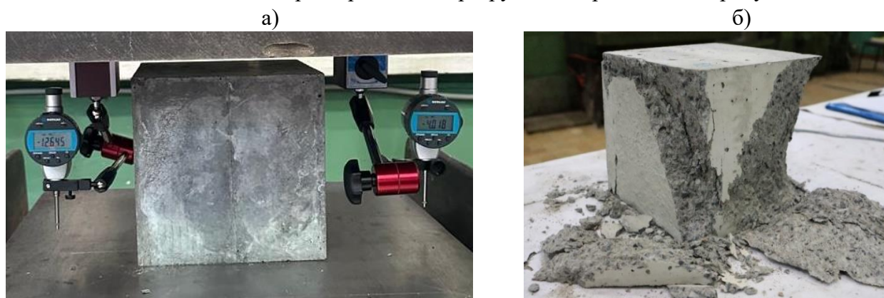
Рисунок 4 – Общий вид моделей-кубов, испытанных на одноосное сжатие.
