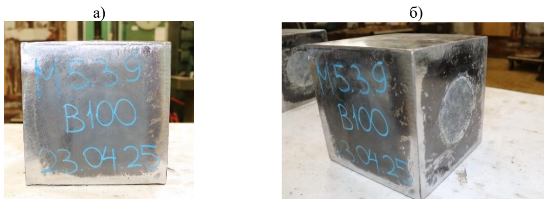
Рисунок 9 – Общий вид моделей-кубов, испытанных на трехосное сжатие. Бетон В30 и В100, с листовым армированием: а) до испытаний; б) после испытаний
