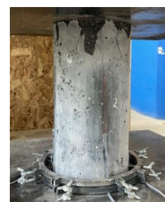
Рисунок 2б – Образец, доведенный до пиковой разрушающей нагрузки
