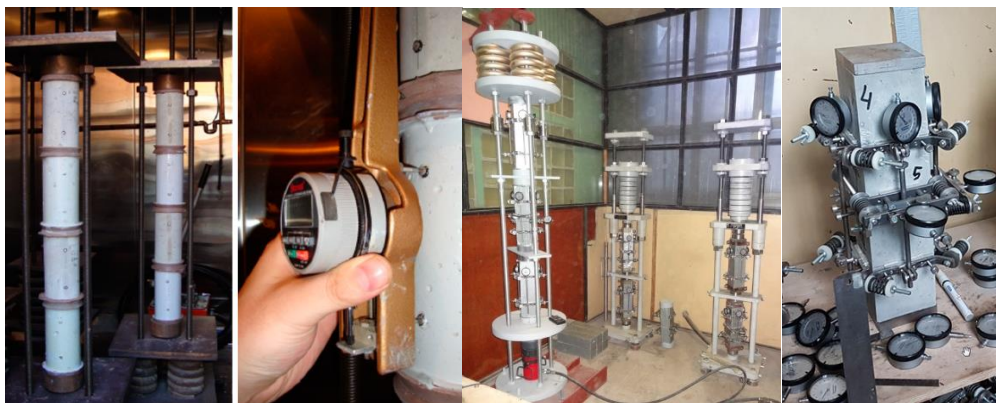
Рисунок 4 - Испытания по определению ползучести бетона по ASTM C512 (слева) ГОСТ 24544 (справа)
