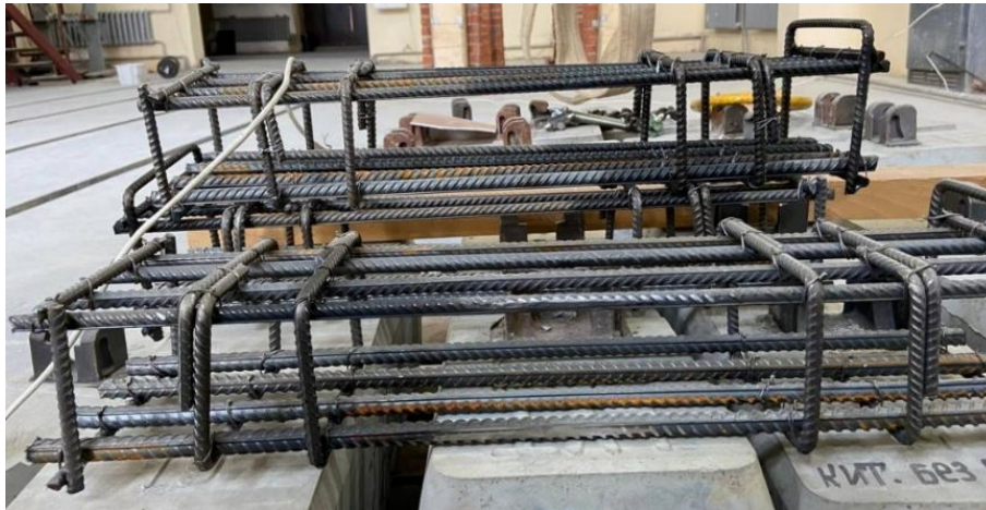
Рисунок 2 – Арматурный каркас полушпалы
